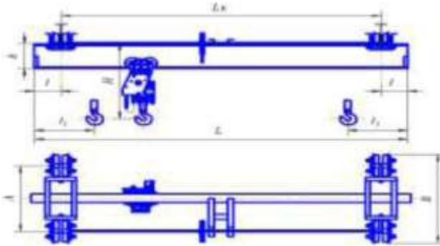
Краны подвесные ручные однобалочные предназначены для подъема и перемещения груза в помещениях или под навесом при температуре окружающей среды от -40°С до +40°С. Изготавливаются общепромышленного, взрывоопасного и пожаробезопасного исполнения, для холодного, умеренного климата. Имеется сертификат Соответствия. Тяговое усилие механизма передвижения крана — 190 Н.
